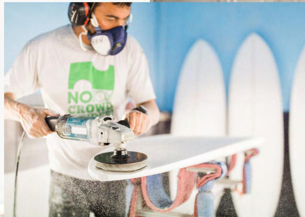
La préparation traditionnelle du pain de mousse émet des particules d'EPS, ce qu'évite le thermoformage (et l'impression 3D). La CNC permet l'automatisation de la manip mais n'est pas en soi une garantie de qualité. En faisant l'économie d'un ou deux passages de la machine, l'état de surface peut ne pas être idéal et fait l'objet d'un rattrapage par de l'époxy moussant, qui peut générer de gros problèmes s'il est mal dosé. (c) Notox
