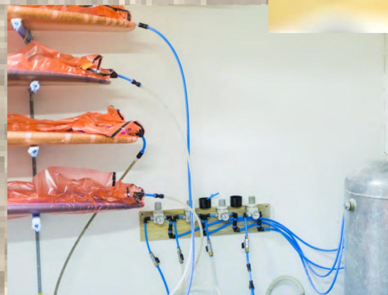
La mise sous vide permet d'optimiser la répartition de résine, ce qui se traduit in fine par moins de poids et plus de solidité, néanmoins elle génère des déchets et consomme plus de résine car les consommables (tissu d'arrachage, feutres) en boivent aussi (c) Notox
