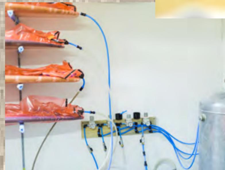
La mise sous vide permet d'optimiser la répartition de résine, ce qui se traduit in fine par moins de poids et plus de solidité, néanmoins elle génère des déchets et consomme plus de résine car les consommables (tissu d'arrachage, feutres) en boivent aussi (c) Notox
