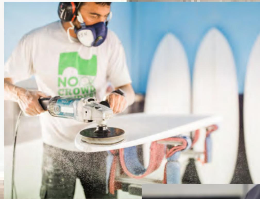
La préparation traditionnelle du pain de mousse émet des particules d'EPS, ce qu'évite le thermoformage (et l'impression 3D). La CNC permet l'automatisation de la manip mais n'est pas en soi une garantie de qualité. En faisant l'économie d'un ou deux passages de la machine, l'état de surface peut ne pas être idéal et fait l'objet d'un rattrapage par de l'époxy moussant, qui peut générer de gros problèmes s'il est mal dosé. (c) Notox
