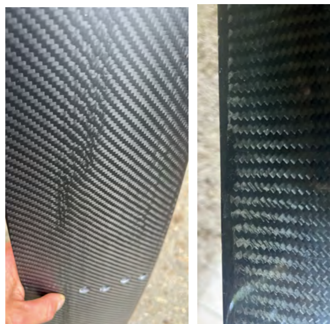
Les irrégularités de ce type (à g.) sur ce qu'on appelle parfois la « couche cosmétique » sont sans conséquences. Mieux vaut en avoir des visibles, que dissimulées derrière de la peinture. Les petites retouches au posca (à d.) ne cachent pas forcément d'horreurs non plus.
